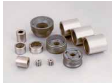
FU-2 Oljeimpregnerad sinterjärn Bärighet 45N/mm 2 . Temperaturområde -80°C ~ +160°C
