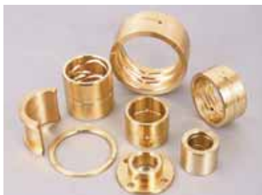
JDB-1U Aluminium, koppar med smörjspår. Bärighet 100N/mm 2 . Temperaturområde >170°C. Max hastighet 1,5 m/s
