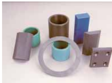
OMC Oljeimpregnerad nylon Bärighet 14-20 MPa Temperaturområde -40°C ~ +80°C
