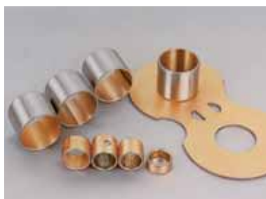
JF-700 Bimetall med koppar och bly Bärighet 25N/mm 2 . Temperaturområde >170°C. Hög hastighet
