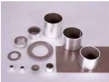
NB1 Ptfе/Bly smörjfri. Bärighet 140N/mm 2 . Temperaturområde -195°C ~ +280°C. Max hastighet 5 m/s
