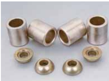
FU-1 Oljeimpregnerad sinterbronsjärn Bärighet 45N/mm 2 . Temperaturområde -80°C ~ +160°C
