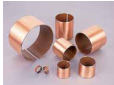
NB1P För fram- och återgående rörelse (Dd2). Bärighet 140N/mm 2 . Temperaturområde -195°C ~ +280°C. Max hastighet 2,5 m/s
