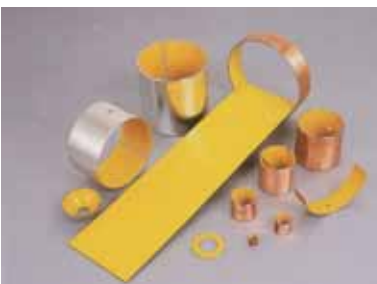
NB2Y Pom blyfri, smörjbar Bärighet 70N/mm 2 . Temperaturområde -40°C ~ +130°C. Max hastighet 2,5 m/s
